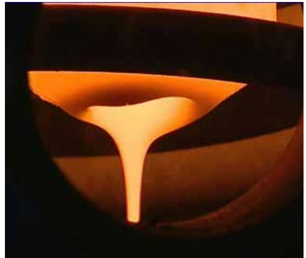
Glasabstich: Aus dem Schmelzofen in die Kokille
