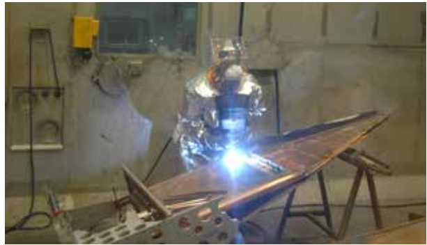
Größere Komponenten werden vor ihrer Dekontamination zerlegt.
