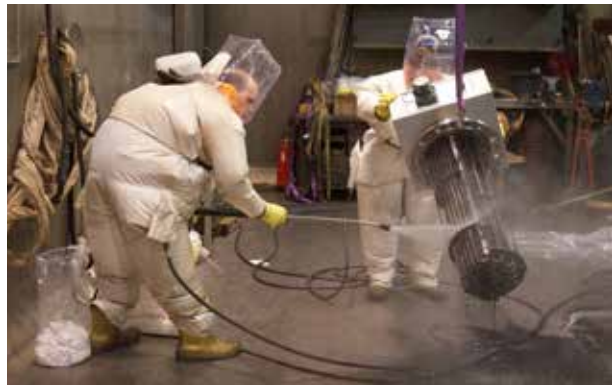
Dekontamination mittels Wasserdruckstrahlen.
