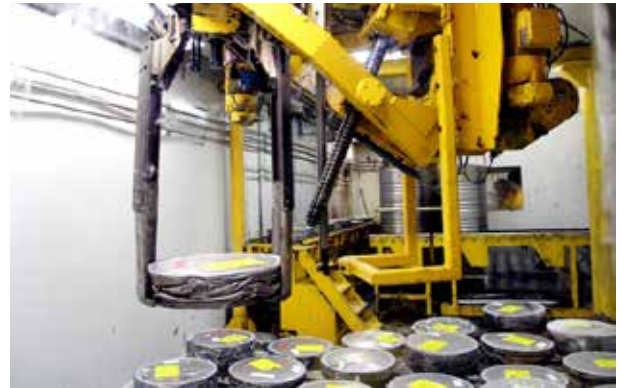
Nicht brennbare Komponenten werden unter hohem Druck zu Pellets gepresst.
