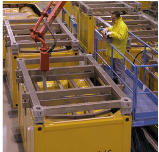
Vergießen von Fassstahlcontainern. Im ersten Schritt mit Niederhalter, um ein „Aufschwemmen“ der Fässer während des Vergießvorganges zu verhindern.
