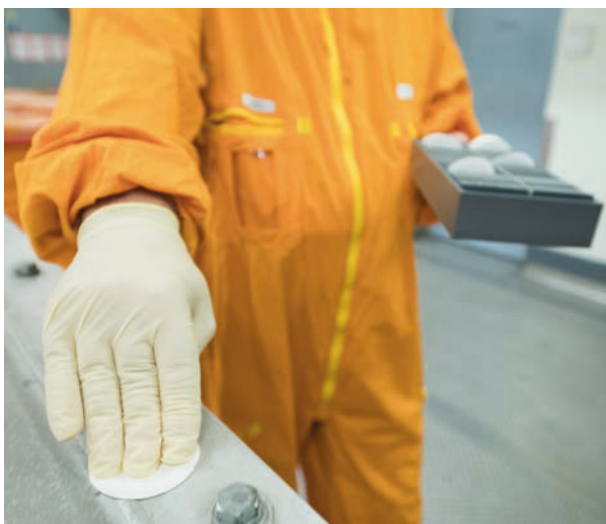
Mit Wischtests wird auf Oberflächenkontamination geprüft.
