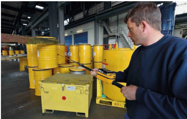
Ein wichtiges Stichwort im Strahlenschutz: Abstand! Mit dem Teletektor kann man auch aus der Entfernung messen.
