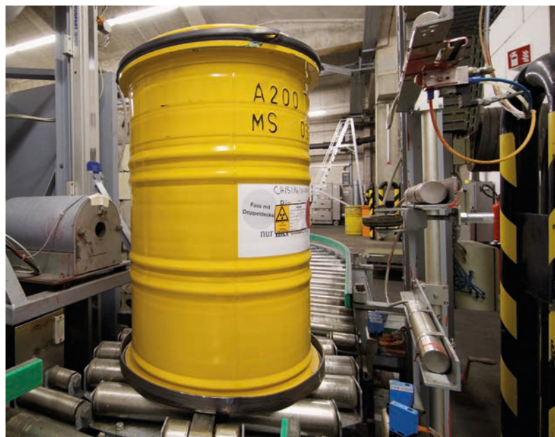
Art, Herkunft und Behandlung radioaktiver Abfälle werden lückenlos dokumentiert, die Werte durch mehrfache Messungen bestätigt – hier: Fassmessenanlage.
