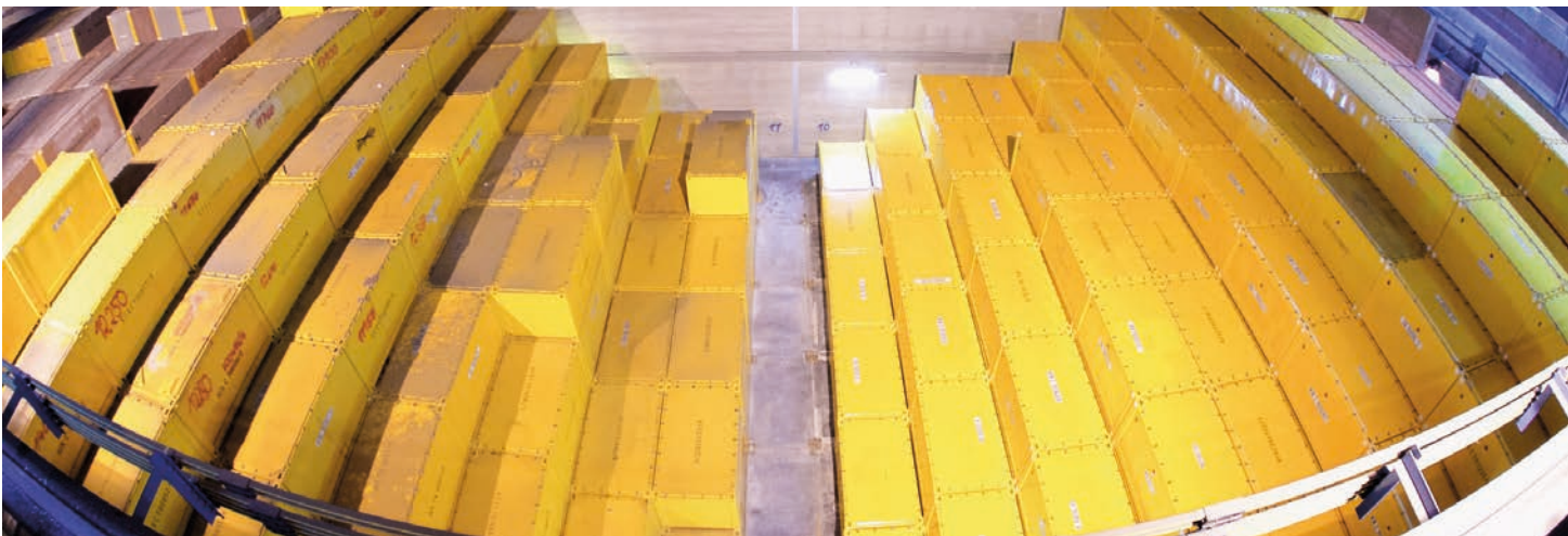
Für die regelmäßige Inspektion der achtfach gestapelten Konrad-Container muss ein tiefer Keil im Zwischenlager L526 gebildet werden.
