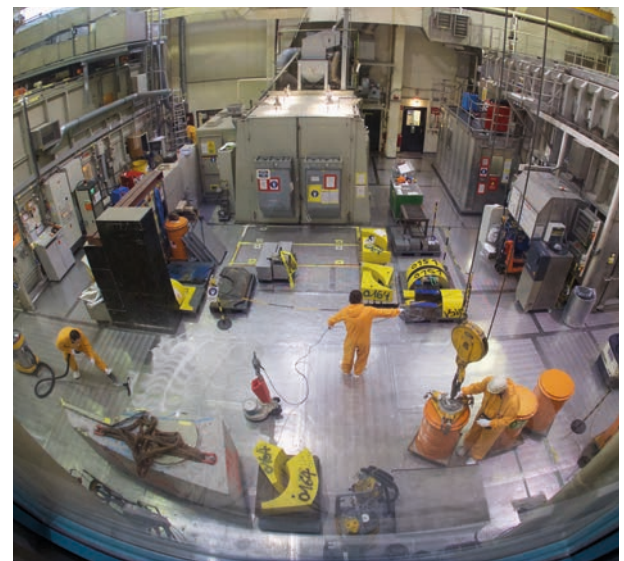
Halle mit Dekocaissons (rechts und links) und einem Caisson zum Sandstrahlen (Mitte).
