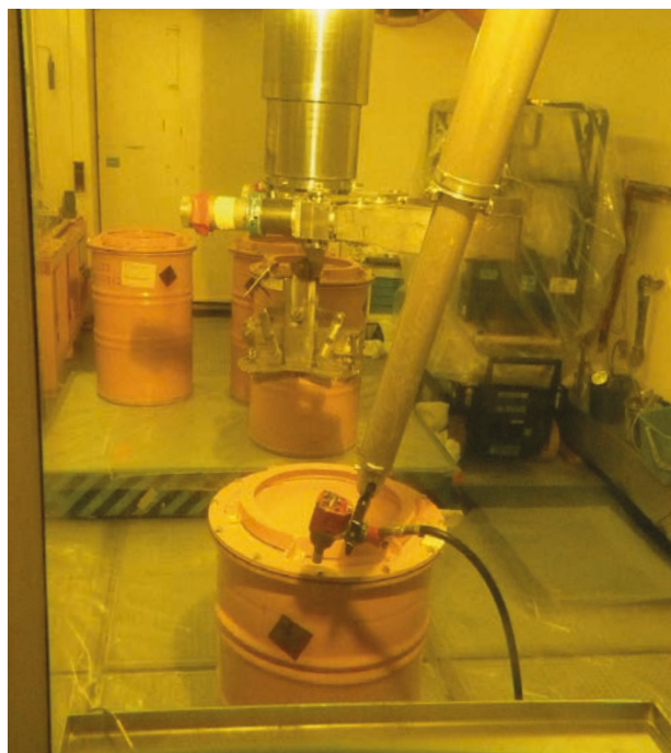
Ein Fass mit MAW-Abfällen wird fernhantiert verschlossen.
