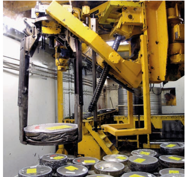
Fässer mit LAW-Abfällen werden gepresst.
