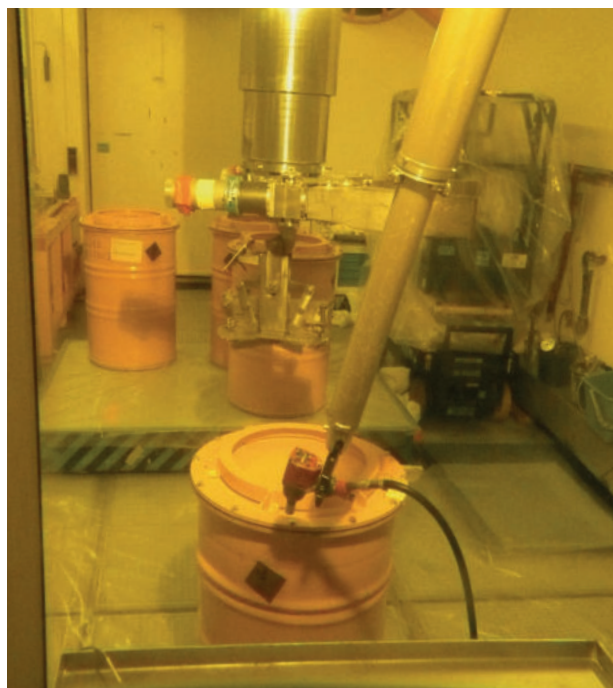
Ein Fass mit MAW-Abfällen wird fernhantiert verschlossen.
