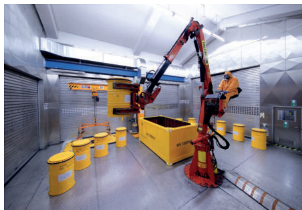
Befüllen eines Containers mittels Fassgreifer.
