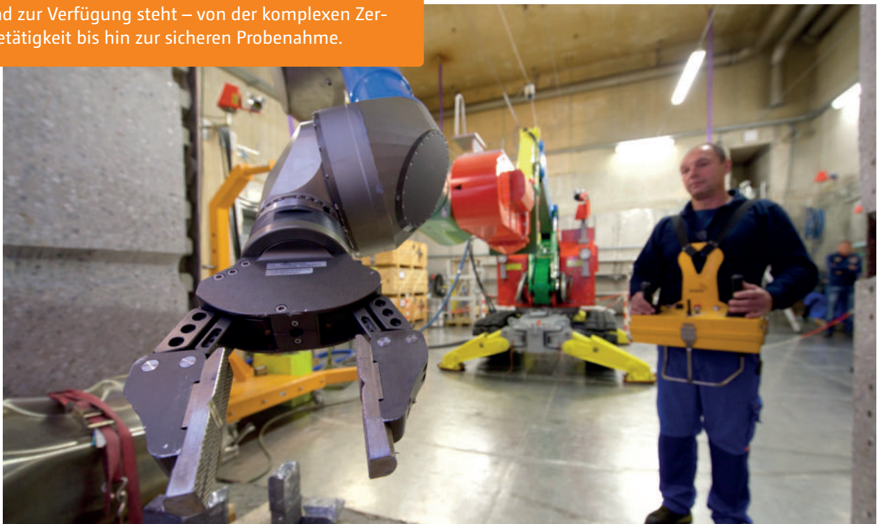
Im werkseigenen Teststand werden die passenden Werkzeuge und Verfahren für alle Arbeitsschritte entwickelt und vor ihrem Einsatz erprobt.
