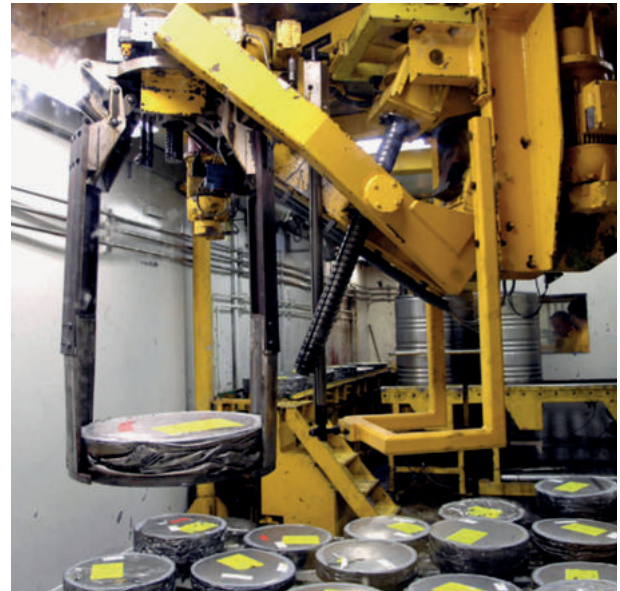
Fässer mit LAW-Abfällen werden gepresst.
