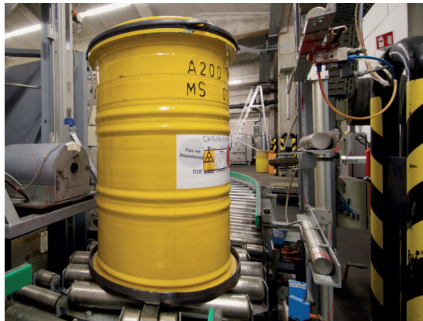
Art, Herkunft und Behandlung radioaktiver Abfälle werden lückenlos dokumentiert, die Werte durch mehrfache Messungen bestätigt – hier: Fassmessenanlage.
