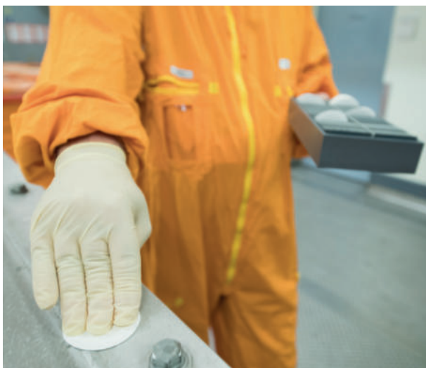
Mit Wischttests wird auf Oberflächenkontamination geprüft.
