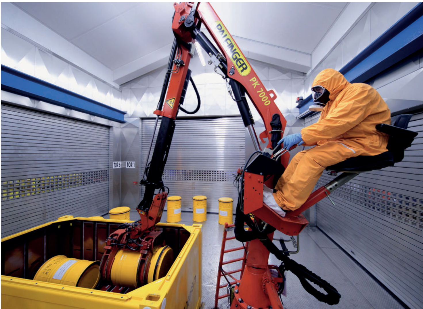
200-l-Fässer werden mit einem Fassgreifer in einen Konrad-Typ IV-Container verpackt.
