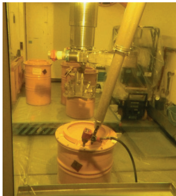
Ein Fass mit MAW-Abfällen wird fernhantiert verschlossen.
