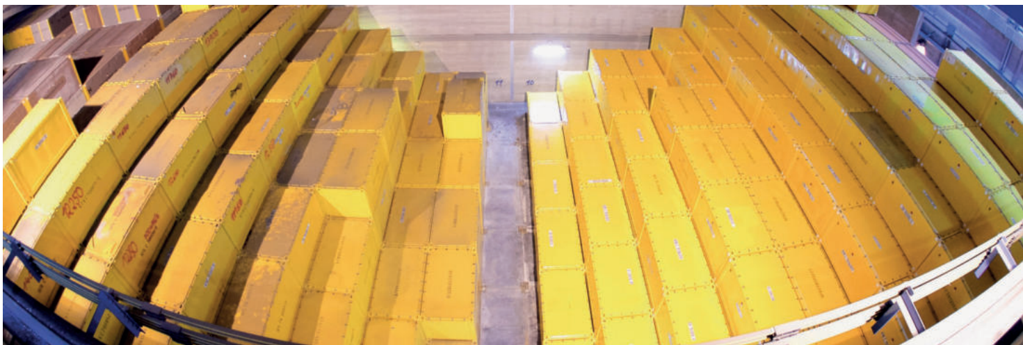
Für die regelmäßige Inspektion der achtfach gestapelten Konrad-Container muss ein tiefer Keil im Zwischenlager L526 gebildet werden.
